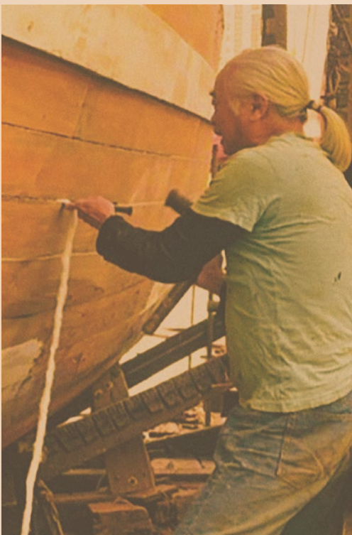
中式造船技術（左圖）是以竹青填充船身的灰路，西式則使用棉花（右圖）。 照片由蒲窩提供。
